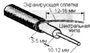
Рисунок 3 - Разделка конца кабеля
